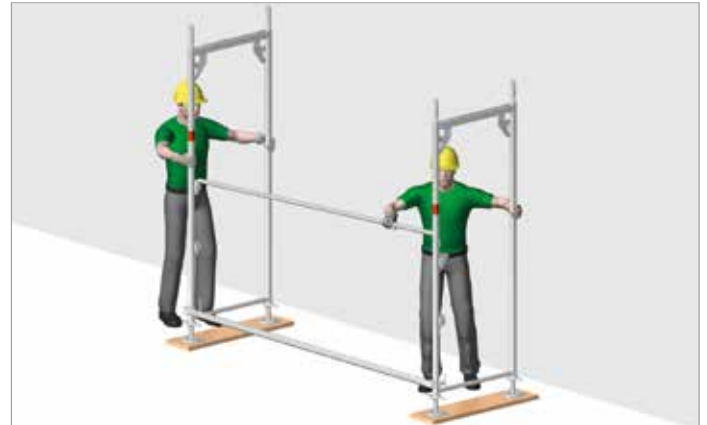
Bild 8: Montering av det första planet: Skyddsräcke, horisontalstag
