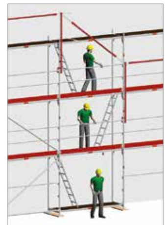
Bild 29: Montera upp MSG skyddsräckesmontagestag
