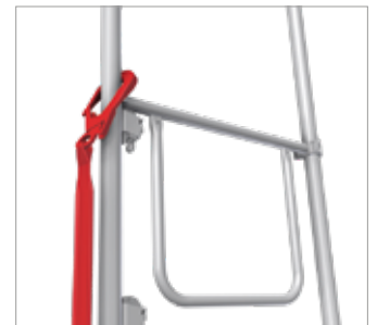
Bild 83: Förankringspunkt i monteringsramen ovan gavelräcket (räckessidan)
