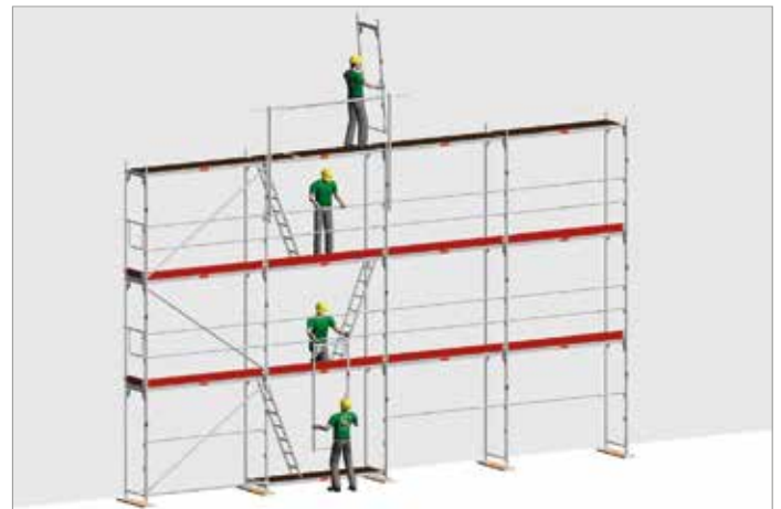
Bild 31: Montering av tillträdesfack med skydd av MSG
