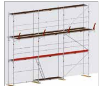
Bild 51: Montering av Skyddstak
