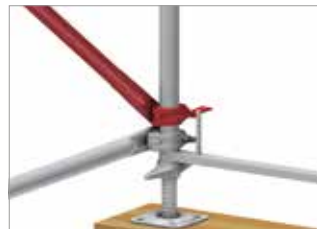
Bild 13: Montera Vertikal-diagonalen i den nedre delen
