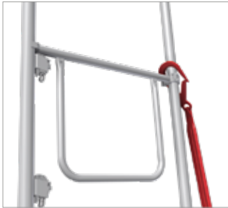
Bild 84: Förankringspunkt i monteringsramen ovan gavelracket (kopplingsidan)
