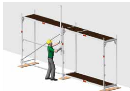
Bild 71: Montering av den första MSG stolpen
