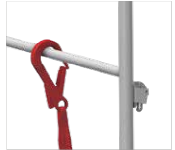
Bild 80: Förankringspunkt i det övre skyddsräcket
