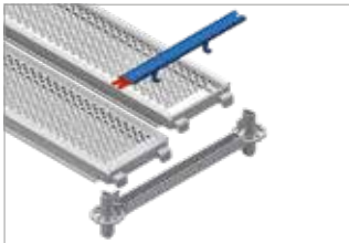
bild 24: Stålp plank monteras i Ubom
