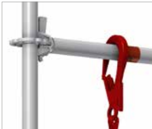
bild 62: Förankring i horisontalstag på minimum 1.0 m nivå över plattformshöjd.
