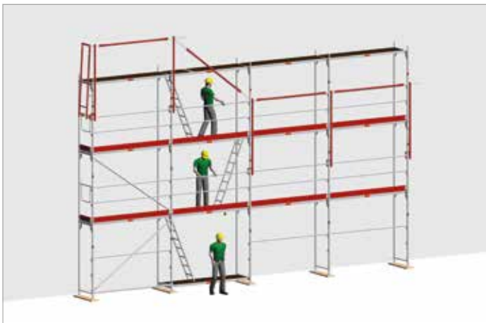
bild 37: Montage av monteräckessystemet (MSG)
