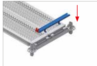
bild 25: Planklåset monteras i Ubommen och låsprofilen i spirkransen
