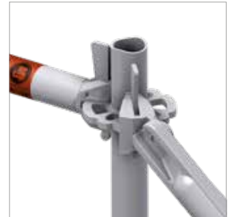
bild 6: Modulkrans med horisontalstag med kilkoppling och diagonalstag med kilkoppling
