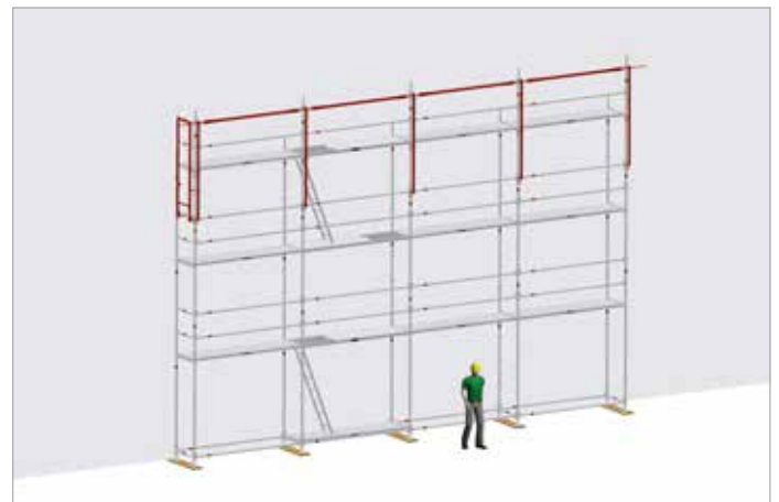
bild 36: Montage av nästa nivå med hjälp av MSG montageskyddssystemet
