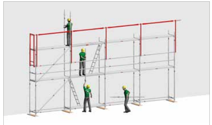
bild 3: Förflyttning av material manuellt och vertikalt uppåt i ställningen
