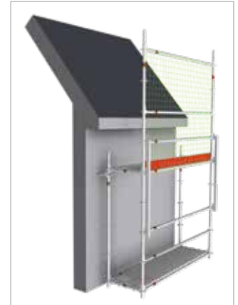
bild 52: Skydds nät med förstärkningsrör, och spirtapp - i höjd med plan
