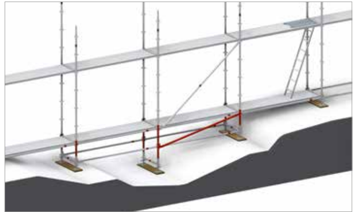
bild 31: Kompensation av markförhållande med hjälp av kort spira
