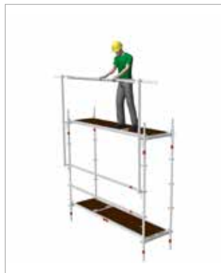
bild 58: Färdigställande av MSG skyddet
