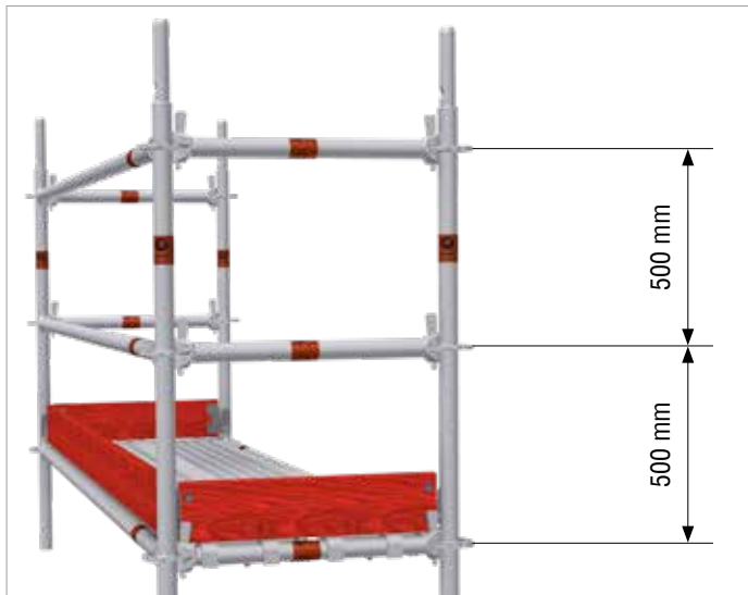
bild 44: Sparklister monterade på tre sidor
