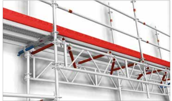
bild 54: Exempel 2. på överbyggnad med fackverksbalk förankrad och förstärkt med V-formerade ställningsrör.
