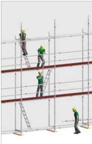
bild 38: Exempel 1 på montage av ställning med PFU
