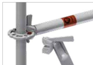
bild 14: Montering av kilkoppling på modulkransen
