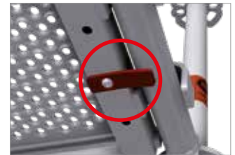
bild 23: Låsningen är vriden så att planet inte kan lyfta vid eventuell vindlast
