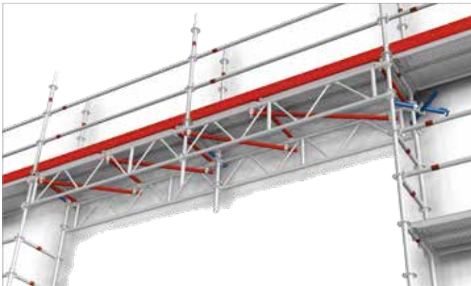
bild 53: Exempel 1. på överbyggnad med fackverksbalk förankrad och förstärkt med V-formerade ställningsrör.
