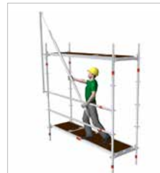
bild 56: Montering av MSG skyddsräcke
