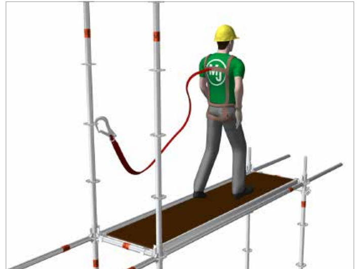
bild 64: Förankring i modulkransen innan montage av horisontalstag, max 1.0 m över plattformshöjd
